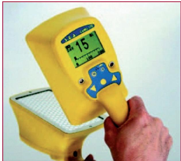
**Fig. 2 - Le moniteur de contamination CoMo 170 de S.E.A.<sup>1</sup> avec scintillateur plastique**
